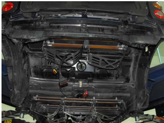
Der Unterboden vor der Elektrifizierung
